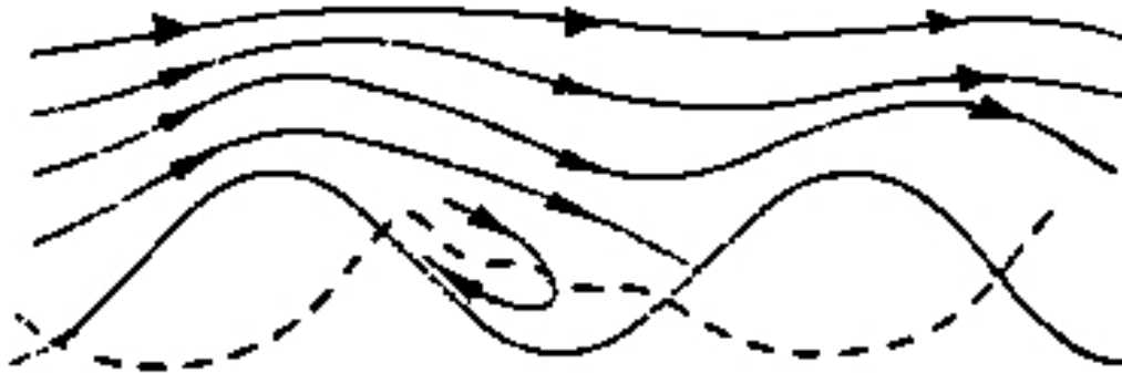
Figure 2.3. Les crêtes importantes représentent un obstacle pour le vent [RAM 80]
