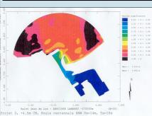
Pour chacune des cinq configurations, l'agitation a été étudiée avec un modèle de diffraction réfraction aux éléments finis (modèle de Berkhoff. elliptique).
