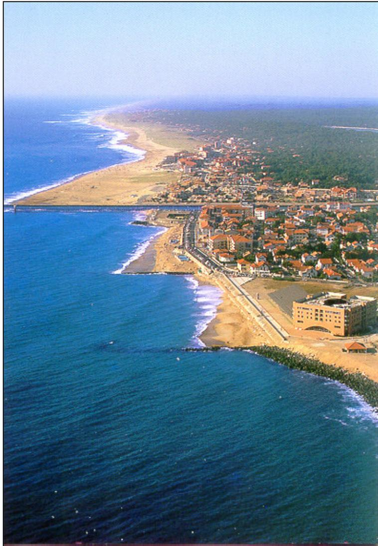
**Figure 5.2** : Interruption du transport littoral à Capbreton dans les Landes.
