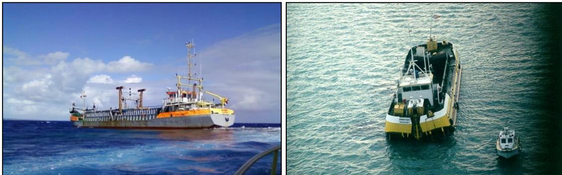
**Figure 1** : a) Chaland à clapets « Mahury » 1000 m<sup>3</sup> – b) Chaland fendable le « Combattant » 500 m<sup>3</sup>.
