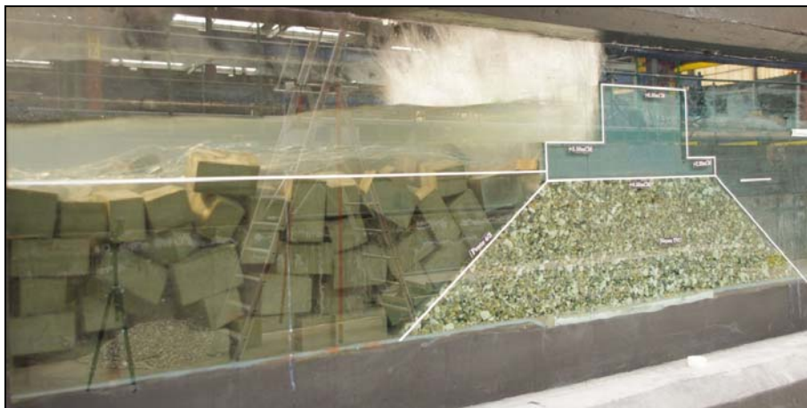
Figure 2. Modèle de l'Artha (ARTELIA) en cours d'essai en houle régulière ( T = 16 s, H = 6 m) avec un niveau d'eau de +4,30 m CM.
